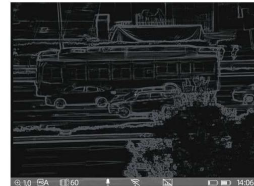
Mode contour de la cible – un double appui sur le bouton permet d'activer/désactiver le mode contour.
